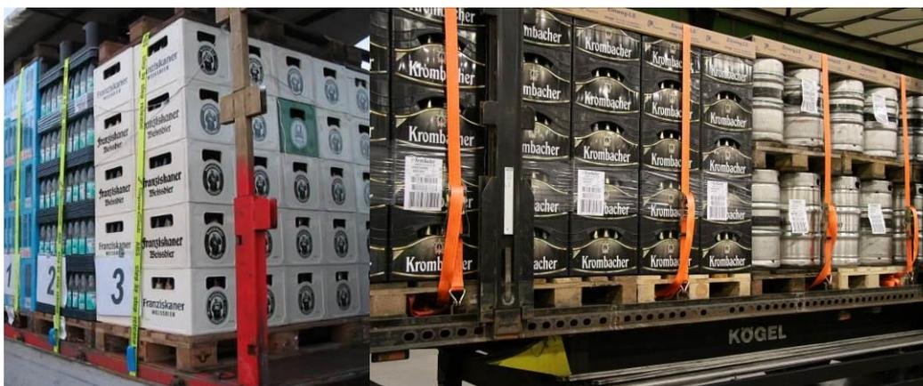
Рис. 4 & 5: Для стабилизации и блокировки необходимы паллеты или подходящий уголкового профиля
